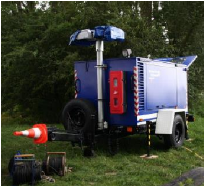
Abb.: NEA mit eingefahrenem Lichtmast
